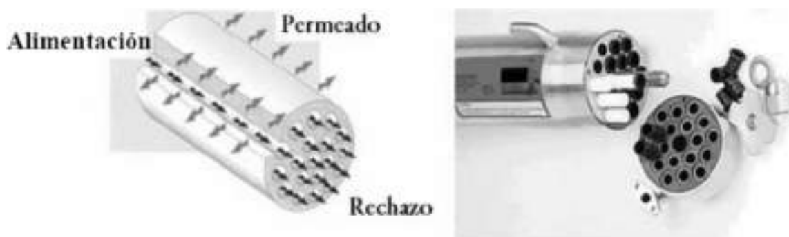
Figura 2.11 Esquema de circulación de flujo de membrana tubular (Poyatos, 2007).
