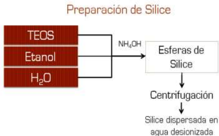
Figura 7. Diagrama de bloques de la síntesis de esferas de sílice monodispersa.
