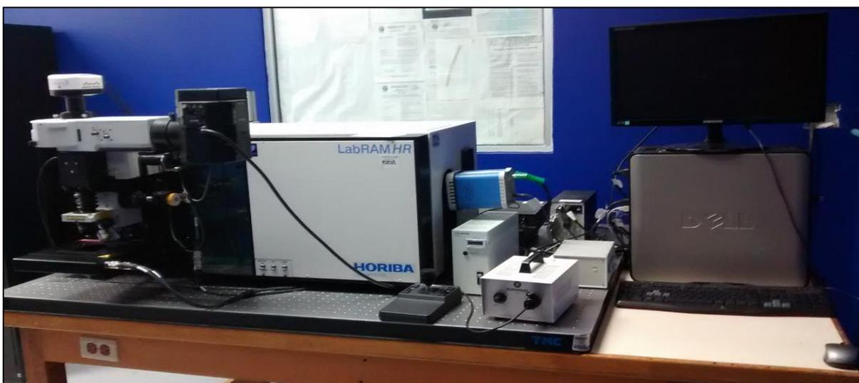
**Figura 3.3.** Micro-espectrómetro Raman (LabRam HR Horiba) utilizado.
