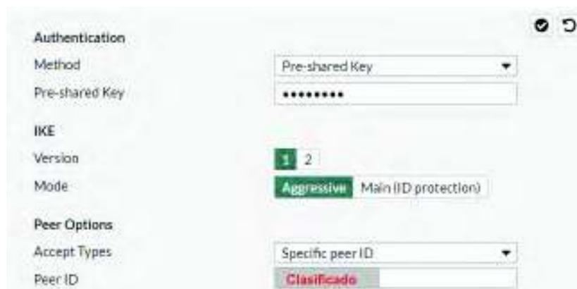
**Figura 4.26** Configuración de Autenticación en COR para Dialup
