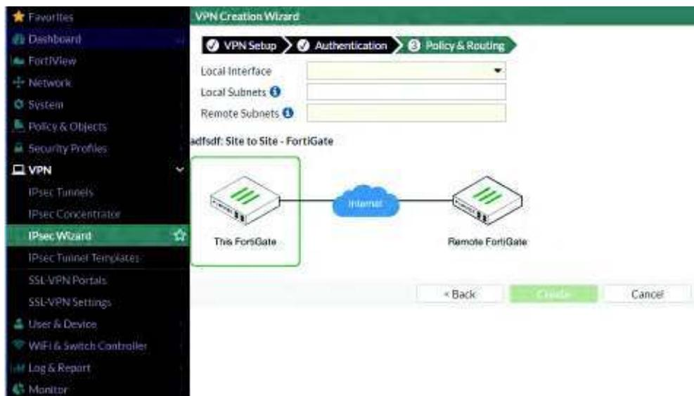
**Figura 4.10** Paso 3 creación de VPN sitio a sitio utilizando el asistente
