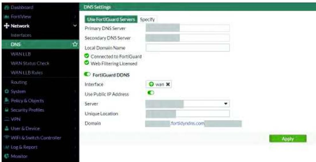
**Figura 4.9** Servicio de DNS dinámico de Fortinet
