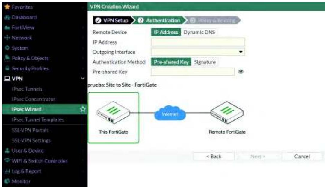
**Figura 4.8** Paso 2 creación de VPN sitio a sitio utilizando el asistente
