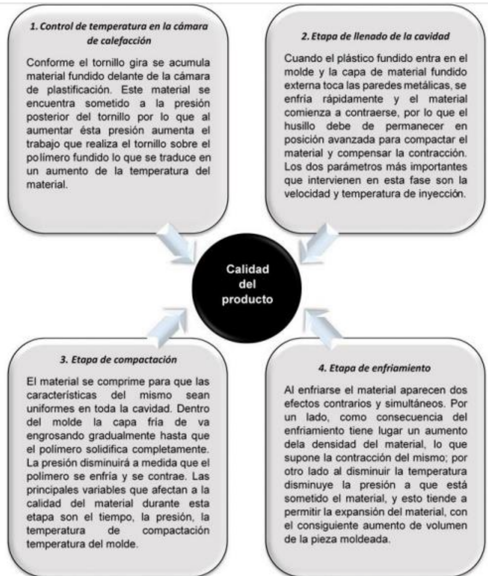
Figura 2.7. Comportamiento del material dentro del molde (Sánchez, 2002).
