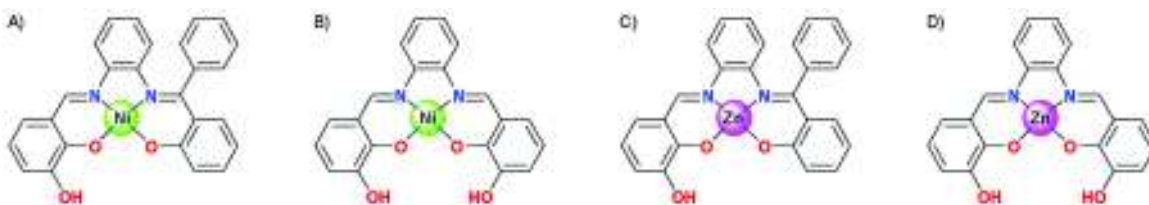
Figura 9. Compuestos M-salfen de níquel y zinc. A) Forma A de Ni-salfen (NiA) con 4 anillos bencénicos y 1 grupo hidroxilo; B) forma B de Ni-Salfen (NiB) con 3 anillos bencénicos y 2 grupos hidroxilo; C) forma A de Zn-salfen (ZnA) con 4 anillos bencénicos y 1 grupo hidroxilo y D) forma B de Zn-salfen (ZnB) con 3 anillos bencénicos y 2 grupos hidroxilo.
