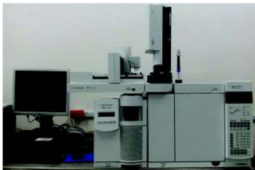
Figura 11. Cromatógrafo de gases Agilent Technologies 7890 acoplado a un espectrómetro de masas cuadro polo simple Agilent 5975C.
