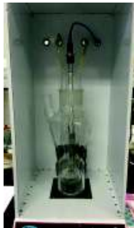
Figura II.1 Reactor para llevar a cabo la degradación del colorante por Foto Fenton heterogéneo.
