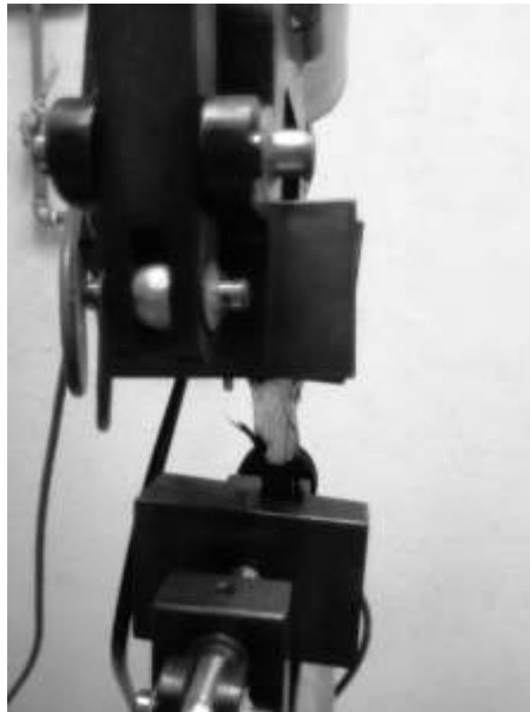
Figura 20. Desprendimiento de NBR entrecruzado sobre la CF de la muestra CF@NBR
