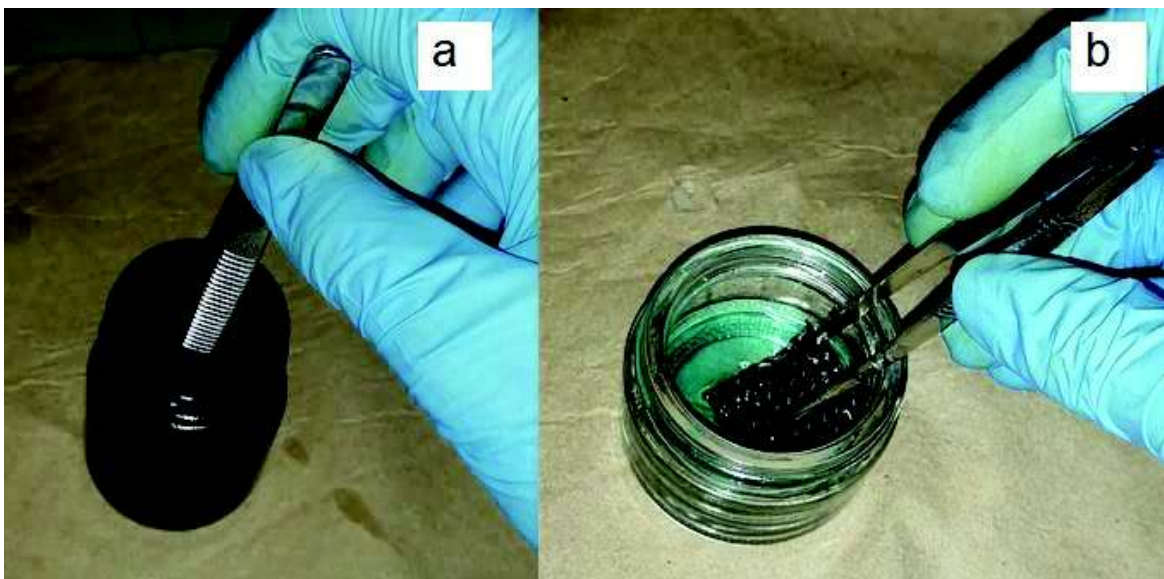
Figura 13. Polimerización del pirrol a) Hinchamiento del NBR entrecruzado con acetonitrilo y pirrol; b) polimerización química con acetonitrilo con perclorato de cobre II como agente oxidante.
