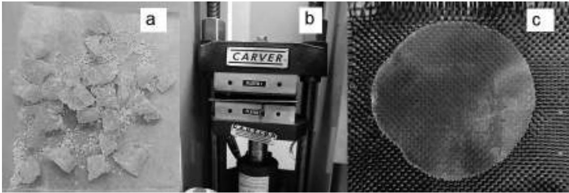
Figura 11. a) Mezcla homogénea de NBR y peróxido de dicumilo; b) Prensa hidráulica modelo Carver 4386; c) Película de NBR entrecruzado sobre CF
