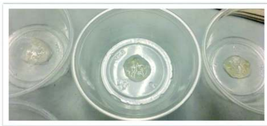
Figura 18. Hidrogeles cargados con sulfato de neomicina
