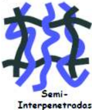
Figura 3. Representación de redes semi-interpenetradas [24]
