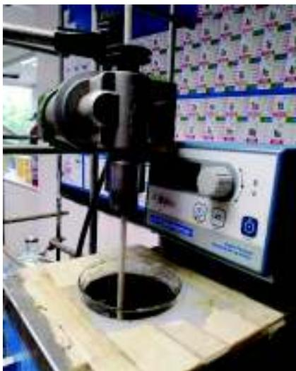
**Fig. 14.** Baño y agitador utilizados para la síntesis.
