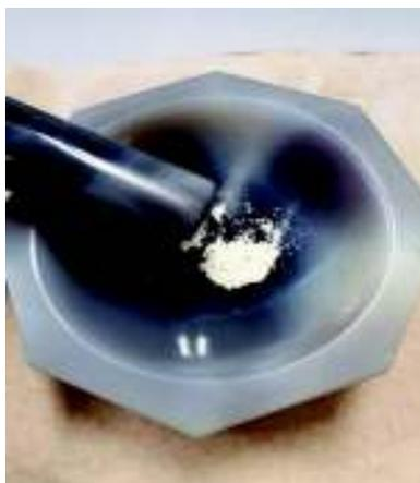
**Fig. 16.** Mortero de ágata utilizado para mezclar ZnO y CeCl<sub>3</sub>.
