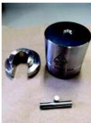
**Fig. 17.** Molde utilizado para la fabricación de pastillas, diámetro de 6 mm.
