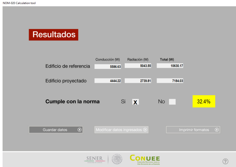
Figura 4.5. Resultados de la simulación de la vivienda A con orientación de su fachada principal al Sur.
