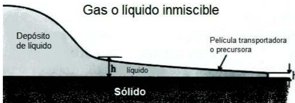
**Figura 3. 2** En la imagen se aprecian las tres fases del sistema y cómo la película precursora se desplaza desde el depósito de líquido a través de la superficie horizontal [17].
