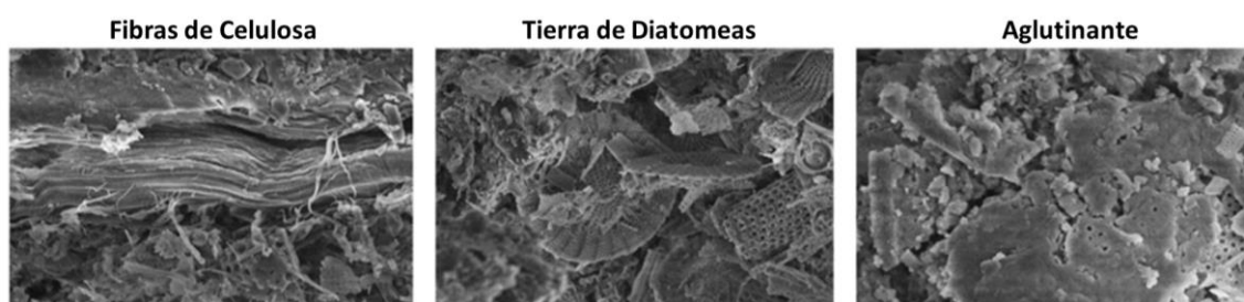
Figura 6: Fibras de celulosa, tierra de diatomeas y aglutinante polimérico. Adaptado de Nejatishahidein et al., 2020
