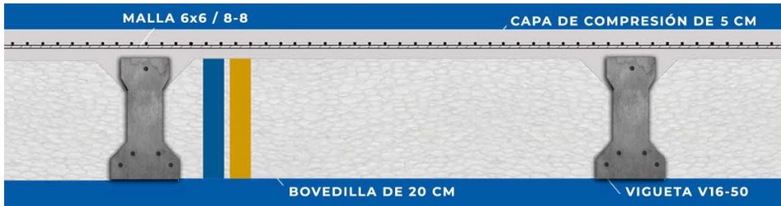
Figura 14 Viguetas de concreto de 16cm con casetón de poliestireno de 20cm
