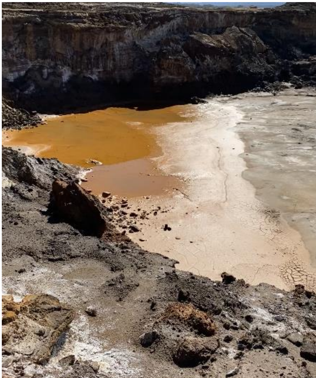
Figura D2. DAM producido por la interacción del agua de lluvia con los jales.
