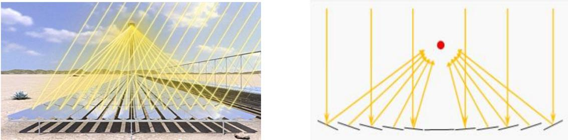
**Figura 3.** Esquema de funcionamiento de un concentrador Fresnel.(LACYQS, 2015)
