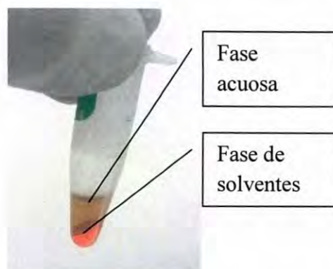
Figura 6.- Fases del centrifugado de hepatopáncreas de camarón en fase acuosa donde se encuentra la glucosa y la proteína total y fase de solventes donde se encuentran los lípidos totales, acilglicéridos y esteroides.
