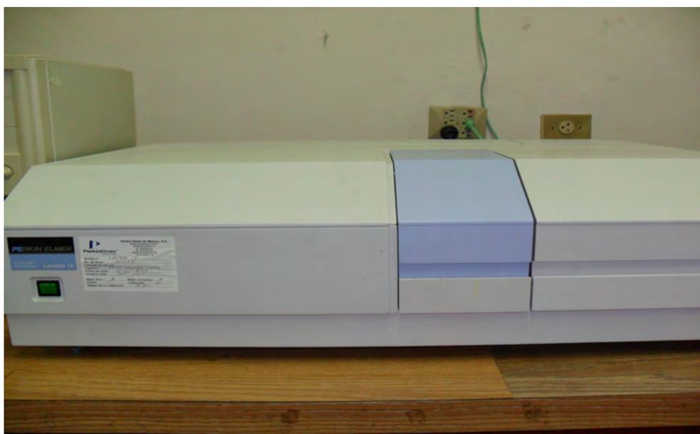
Figura 3.6: Equipo de absorción Lambda Spectrometer 19.
