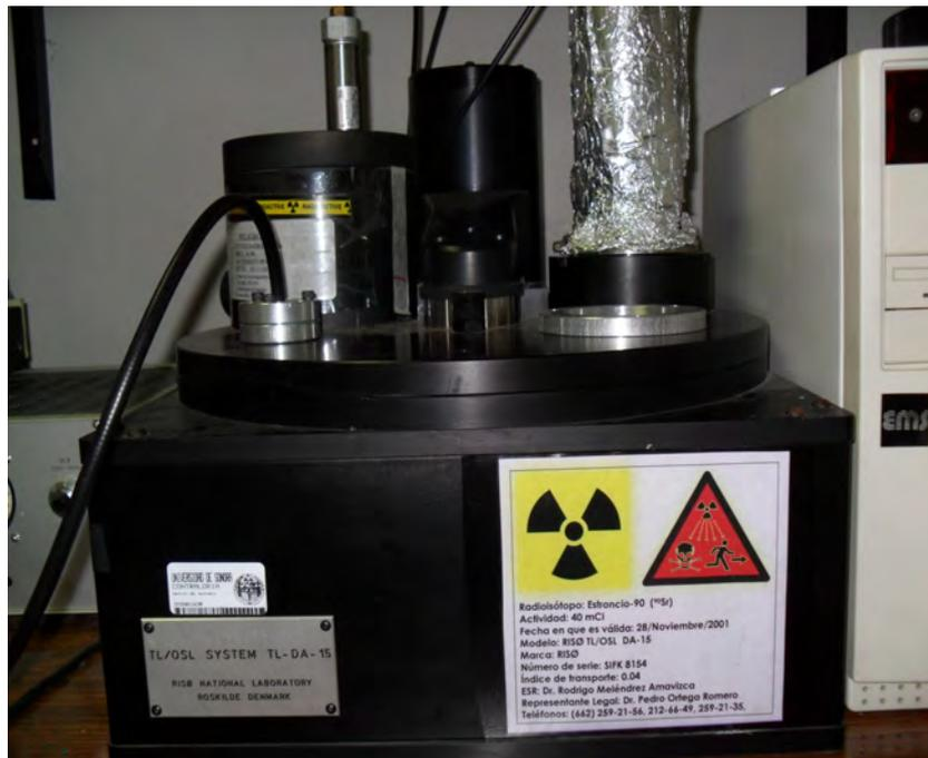
Figura 3.11: Equipo Riso TL/OSL para realizar experimentos de termoluminiscencia.
