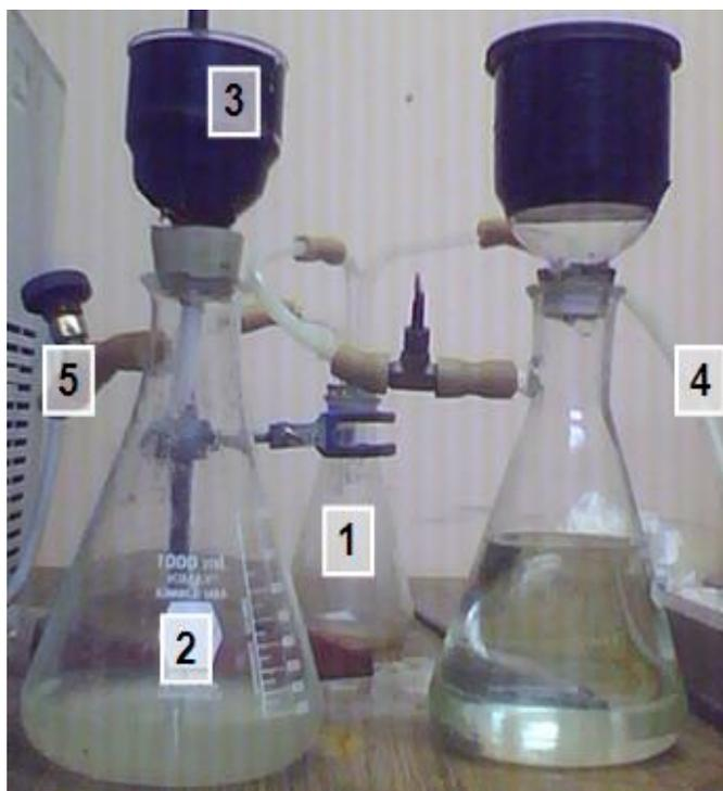
*Fig. 2.2. Equipo de recuperación de muestra por filtrado.*
