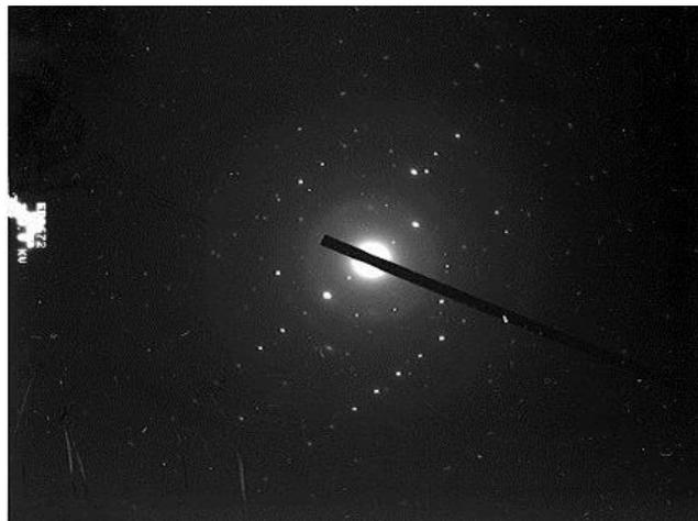
**Fig. 3.49. Patrones de difracción de laue producido por nanopartículas de PbSe en clinoptilolita.**
