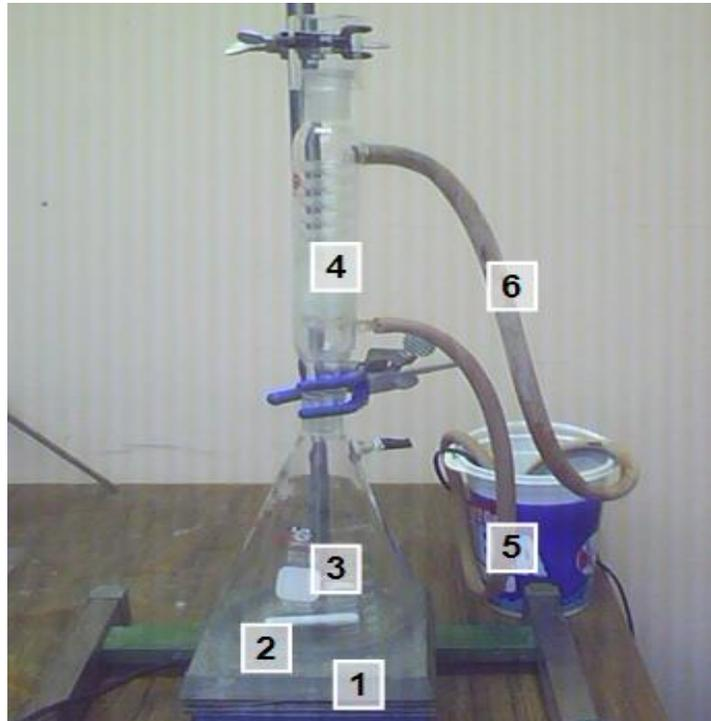
*Fig. 2.1. Equipo para condiciones de reflujo.*
