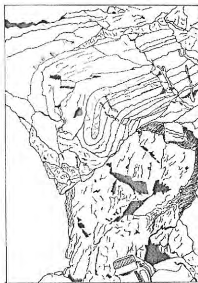
Figura 13.- Estructura de la mineralización en el techo del nivel superior de las obras accesibles (Figura 11). Nótese la concordancia del cuerpo mineralizado con las rocas encajonantes. Cuerpo mineralizado y rocas encajonantes están afectados por una misma esquistosidad S1 \parallel S0 . Dibujo sobre foto de una superficie de aproximadamente 3.75 m x 2.75 m. Mina San Cristóbal.
