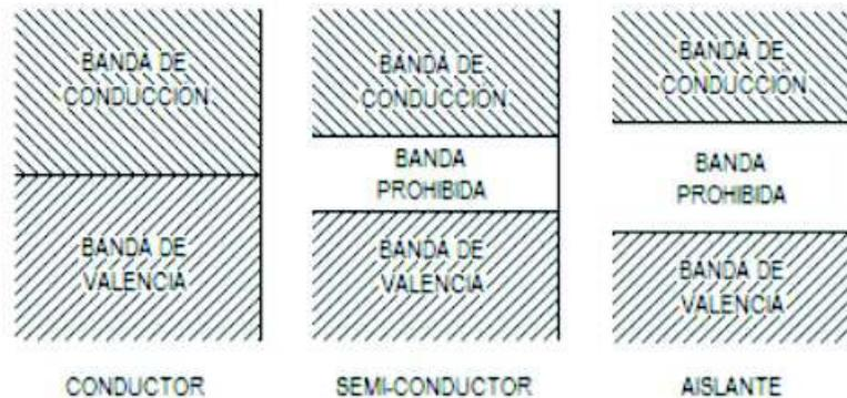
Figura 1.1.2.1.- Banda de energía prohibida correspondiente a los materiales: conductor, semiconductor y aislante.
