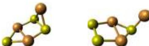
Figura 4-3. Estructuras de  $(\text{CuS})_3$  calculadas con PBE (izquierda) y PBE0 (derecha), utilizando la base TZVP para S y el pseudopotencial CRENBs para Cu.
