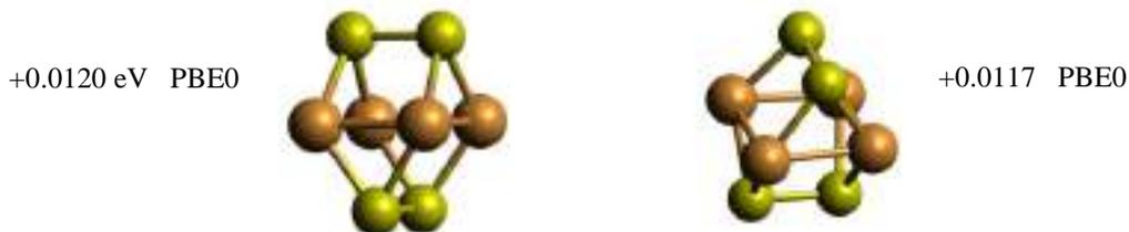
Figura 8-3.- Isómeros de  $(\text{CuS})_4$  calculados con PBE0, utilizando la base TZVP para S y el pseudopotencial CRENBs para Cu.
