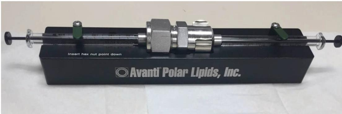
Figura 1.5. Extrusor utilizado para preparación de liposomas nanométricos.
