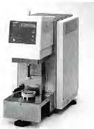
Figura 3-1 Reómetro SR5 utilizado en las mediciones
