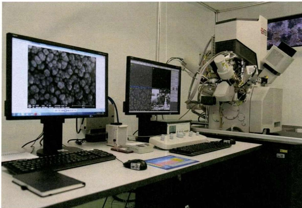
*Figura 5. Instrumento utilizado para el estudio FEI modelo SCIOS.*
