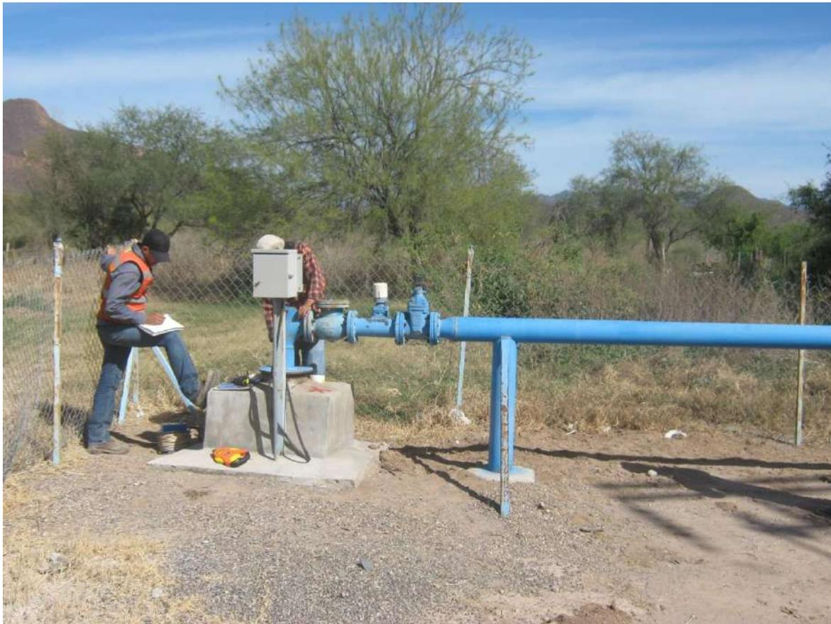
Ilustración 9. Prueba de bombeo, pozo Agua potable Suaqui Grande.
