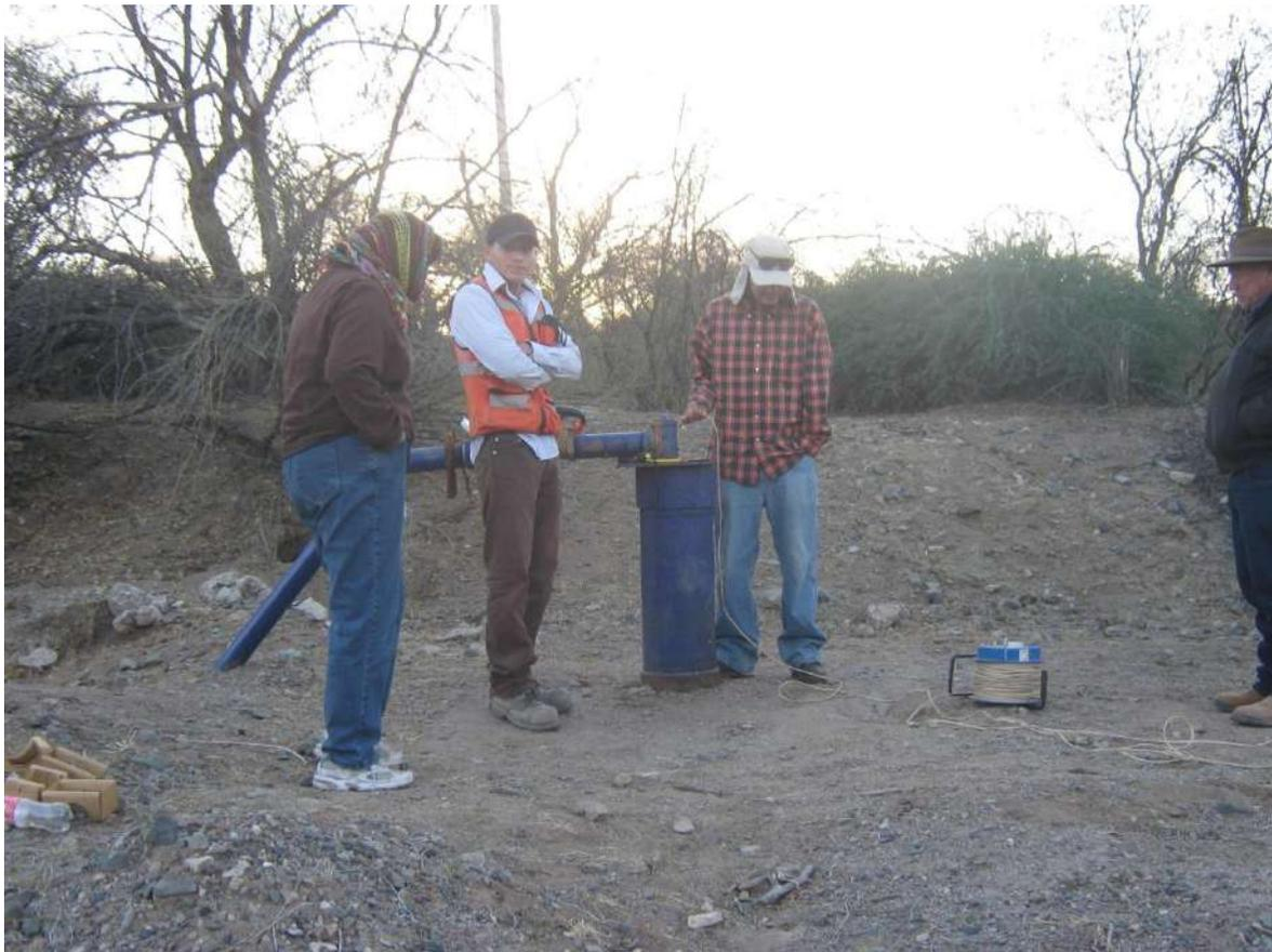
Ilustración 13. Prueba de bombeo, pozo Agua Potable Tecoripa.
