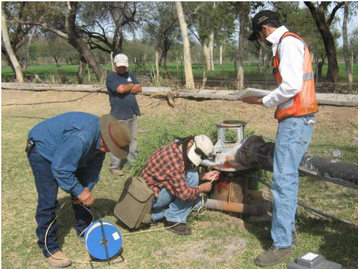
Ilustración 5. Prueba de bombeo, pozo El Tunal.
