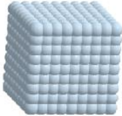
Figura 2.2.2 Se muestra la nanopartícula cúbica compuesta por varios dipolos eléctricos [11].
