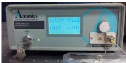
(a) Diodo laser DFB a 1550nm con potencia de 7.14mW
