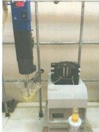
**Figura 8.** Configuración experimental para la preparación de nanopartículas de quitosano.
