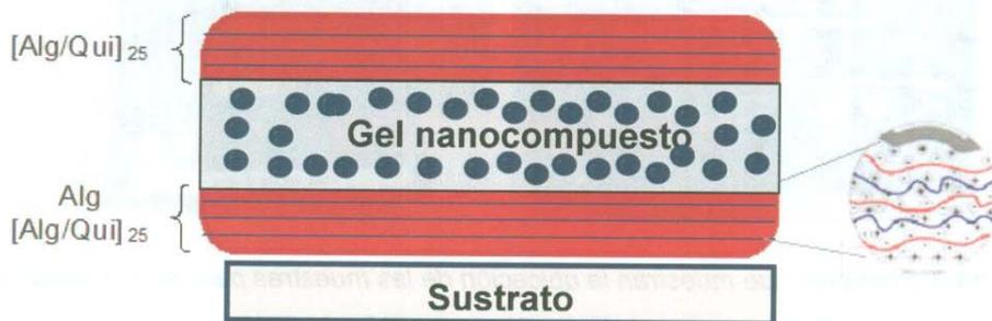
**Figura 9.** Esquema del hidrogel nanocompuesto tipo sándwich. Los círculos amarillos representan las partículas de quitosano/BSA.
