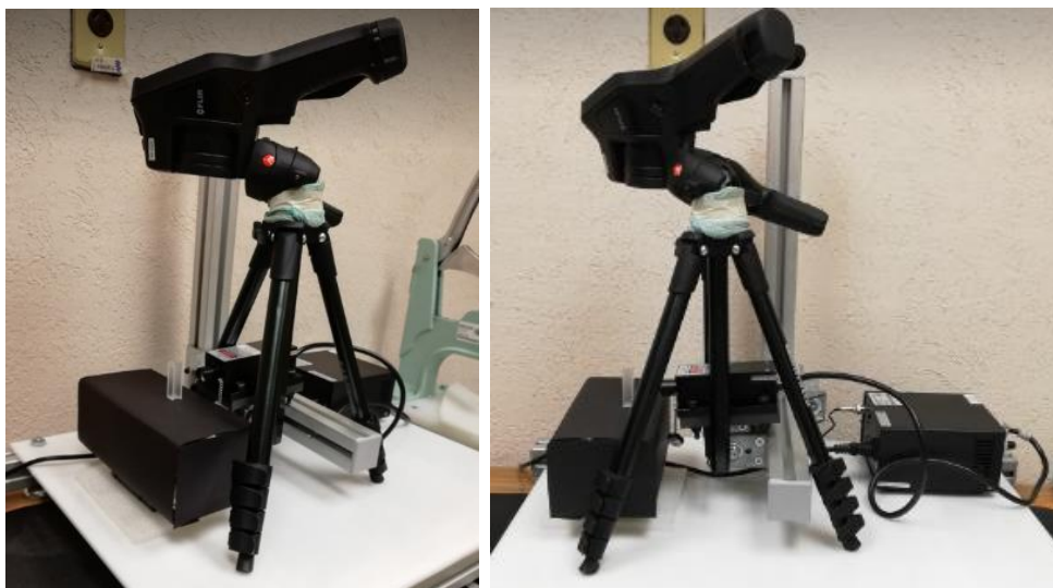
Figura 17. Sistema utilizado para mediciones de efecto fototérmico.
