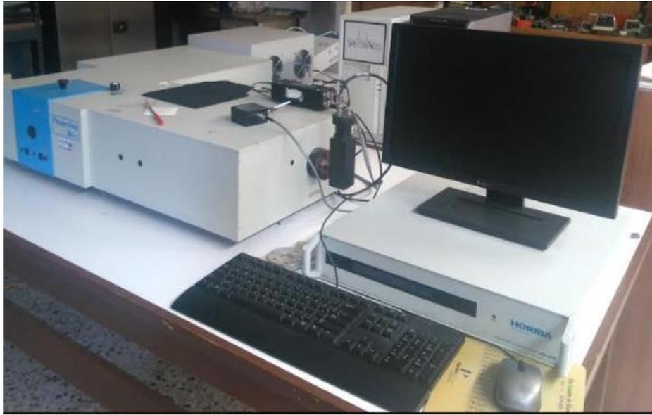
Figura 10. Equipo FluoroLog-3 TCSPC (Horiba, Jobin-Yvon,) Modelo FL3-22 utilizado para las mediciones de PL, PLE, tiempos de vida y luminiscencia dependiente a la temperatura.
