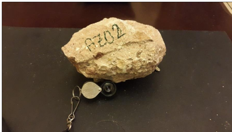
Imagen 4. Muestra de mano de conglomerado arenoso (AZ02) de la porción conglomerática de la Formación Báucarit en la zona Arizpe-Tahuichopa
