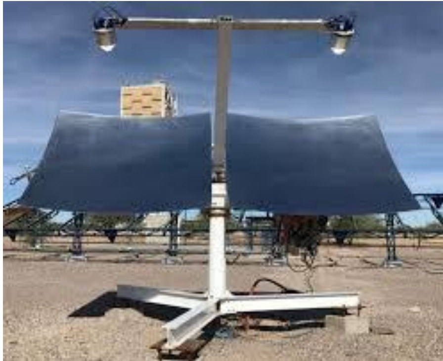
Figura 5. Concentrador PV de disco parabólico con celdas triple unión y óptica Kohler [14].
