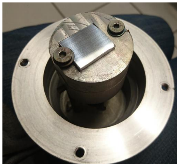
Figura 22. Porta-muestras con un sustrato de aluminio con superficie reflectante antes de realizar depósito ALD.
