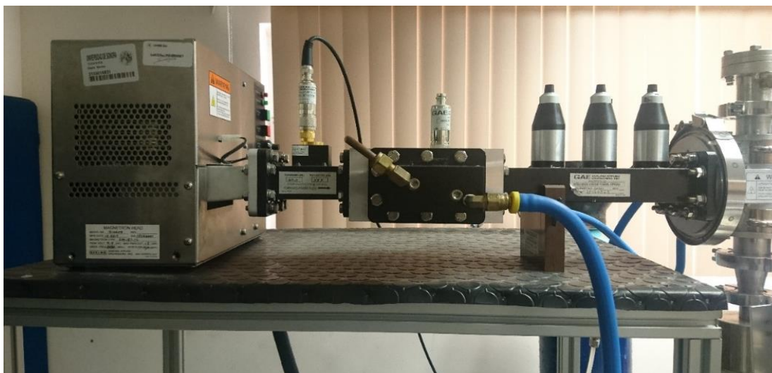
Figura 24. Sistema “Downstream plasma” utilizado para la fabricación del ALD asistido por plasma.
