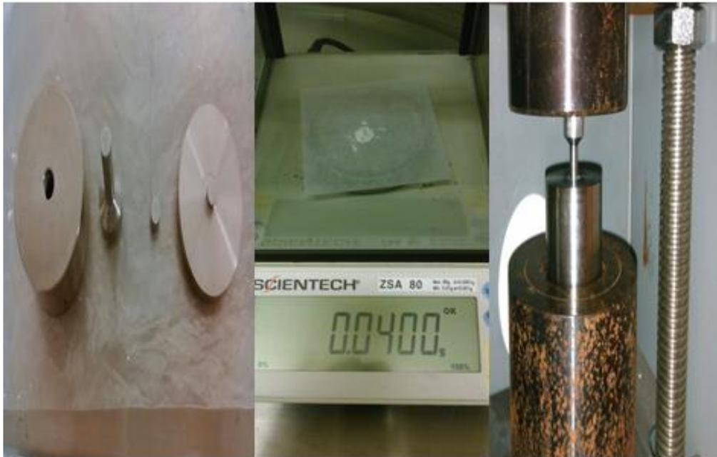
**Figura 9- Molde para la elaboración de pastillas, peso del polvo en balanza y prensa utilizada para la elaboración de las pastillas de Aluminatos de estroncio co-dopados.**
