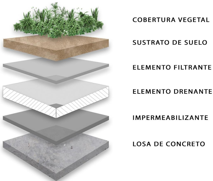
Figura 2 Componentes del techo verde
