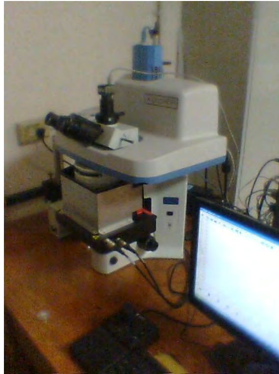
Figura 6.3.- Espectroscopio MicroRaman Horiba Jobin Yvon, utilizado para la captura de los espectros RAMAN.
