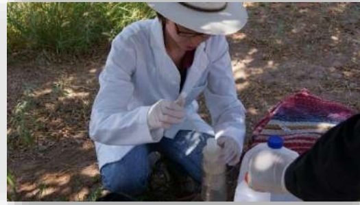
Fotografía 6.2.- Adición de preservador.
