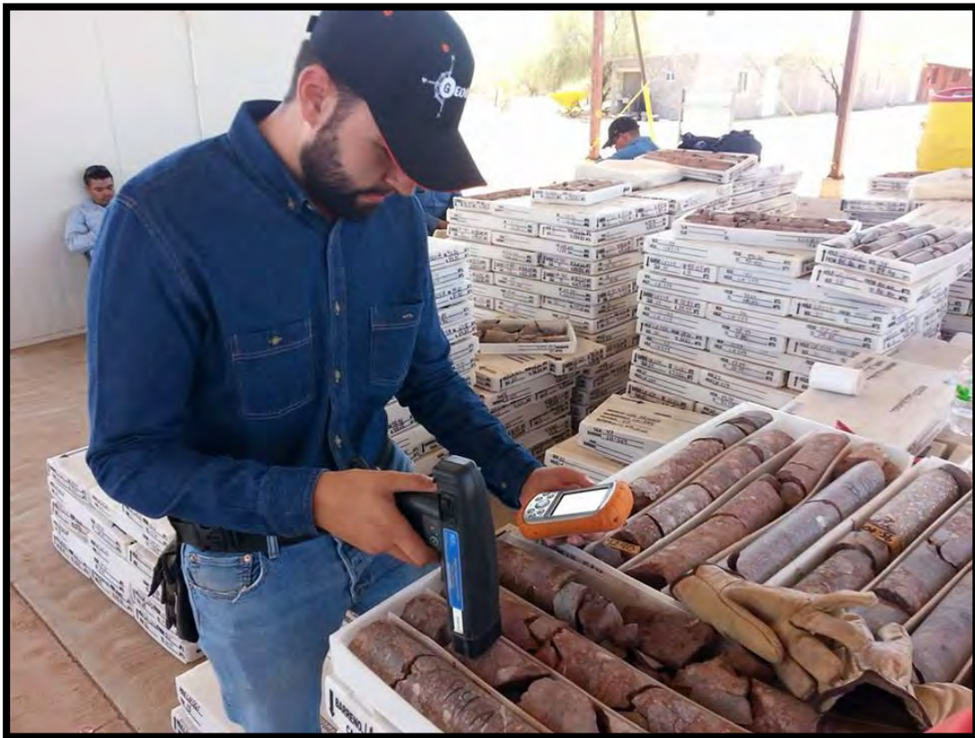
Figura 23. Toma de datos de Susceptibilidad Magnética.
