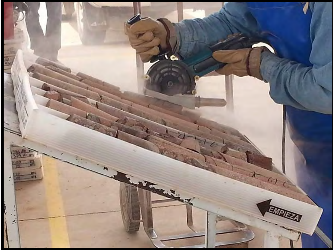
Figura 16. Corte con bafer sobre el núcleo con la probeta instalada.
