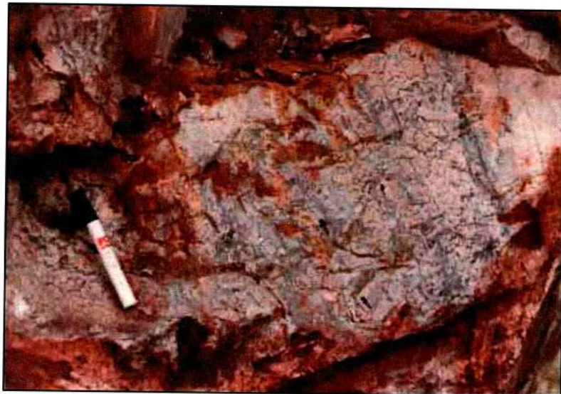
Figura 19.-Veta de cuarzo masivo con molibdenita disseminada desplazando a las vetillas dendríticas, que se encuentran en la parte central del stockwork
