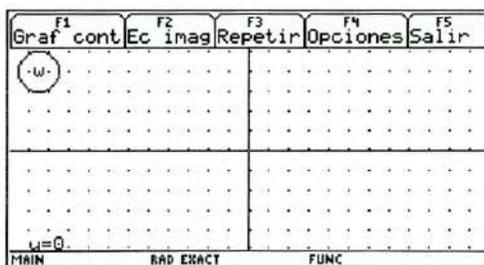
Fig. 1.10(b) Gráfica puntual de la imagen de la recta  $y = 0$  bajo la transformación  $w = -iz^2$  en el plano  $w$ . Se trata de la semirrecta  $u = 0, v \leq 0$ .
