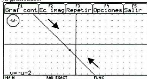
Fig. 5.11(c) Gráfica continua de la imagen de la hipérbola vertical  $y^2 - x^2 = 1$  en el plano  $w$  bajo la transformación  $w = (1+i)z^2$ . Se trata de la recta  $v = -u - 2$ . Dicha recta se grafica dos veces, primero de manera convergente al punto  $(-1, -1)$ , y posteriormente de forma divergente a partir de dicho punto.
