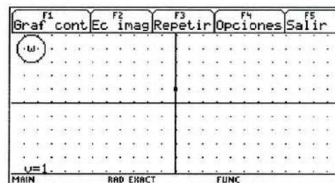
Fig. 5.10(b) Gráfica puntual de la imagen de la hipérbola horizontal  $x^2 - y^2 = 1$  en el plano  $w$  bajo la transformación  $w = iz^2$ . Se trata de la recta  $v = 1$ . Dado que la imagen de los puntos  $(-x, \pm y)$  y  $(x, \pm y)$  es la misma, entonces en la figura no se distingue la imagen de tal recta, esto es debido a que la calculadora primero grafica la
