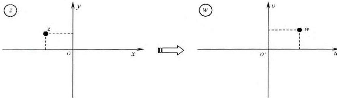
Figura 1 El plano  $z$  (original) y el plano imagen  $w$ . Transformación puntual.
