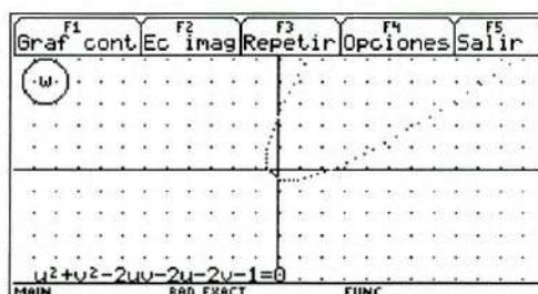
Fig. 1.11(b) Gráfica puntual de la imagen de la recta  $y = 1/2$  en el plano  $w$  bajo la transformación  $w = (1+i)z^2$ .
