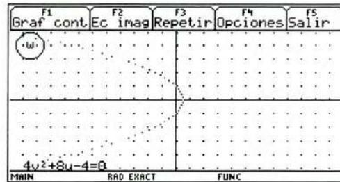
Fig. 3.1(b) Gráfica puntual de la imagen de la recta  $y = x + 1$  en el plano  $w$  bajo la transformación  $w = iz^2$ . Se trata de la parábola  $v^2 + 2u - 1 = 0$ , cuyo vértice es el punto  $\mathbf{V}(1/2, 0)$ .
