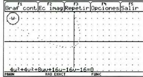
Fig. 3.13(b) Gráfica puntual de la imagen de la recta  $y = x + 1$  en el plano  $w$  bajo la transformación  $w = (1+i)z^2$ .
