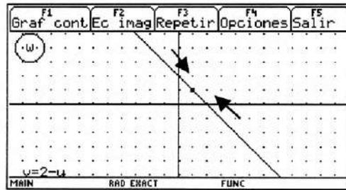
Fig. 5.7(c) Gráfica continua de la imagen de la hipérbola horizontal  $x^2 - y^2 = 1$  en el plano  $w$  bajo la transformación  $w = (1 + i)z^2$ . Se trata de la recta  $v = -u + 2$ . Dicha recta se grafica dos veces, primero de manera convergente al punto  $(1,1)$ , y posteriormente de forma divergente a partir de dicho punto.
