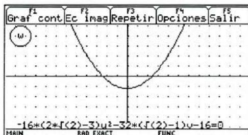
Fig. 3.3(c) Gráfica continua de la imagen de la recta  $y = (\sqrt{2} - 1)x + 1$  en el plano  $w$  bajo la transformación  $w = (1 + i)z^2$ . Se trata de la parábola  $16(3 - 2\sqrt{2})u^2 - 32(\sqrt{2} - 1)v - 16 = 0$ , cuyo vértice es el punto  $V\left(0, -\frac{\sqrt{2} + 1}{2}\right)$ .
