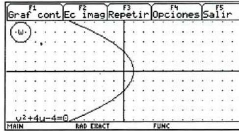
Fig. 2.1(c) Gráfica continua de la imagen de la recta  $x = 1$  en el plano  $w$  bajo la transformación  $w = z^2$ . Se trata de la parábola  $v^2 + 4u - 4 = 0$ , cuyo vértice es el punto  $V(1,0)$ .
