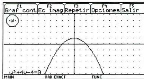
Fig. 2.7(c) Gráfica continua de la imagen de la recta  $x = 1$  en el plano  $w$  bajo la transformación  $w = iz^2$ . Se trata de la parábola  $u^2 + 4v - 4 = 0$ , cuyo vértice es el punto  $V(0,1)$ .
