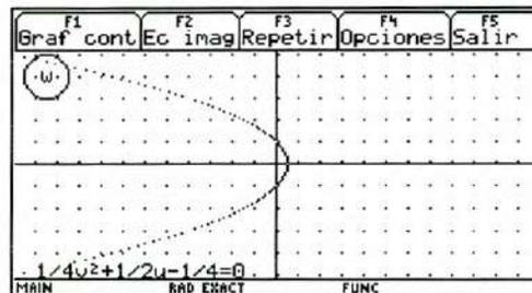
Fig. 1.2(b) Gráfica puntual de la imagen de la recta  $y = 1$  en el plano  $w$  bajo la transformación  $w = -1/2z^2$ . Se trata de la parábola  $v^2 + 2u - 1 = 0$ , cuyo vértice es el punto  $V(1/2, 0)$ .
