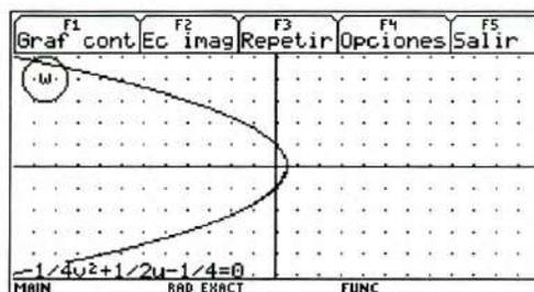
Fig. 1.2(c) Gráfica continua de la imagen de la recta  $y = 1$  en el plano  $w$  bajo la transformación  $w = -\frac{1}{2}z^2$ .
