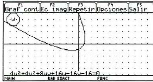
Fig. 3.13(c) Gráfica continua de la imagen de la recta  $y = x + 1$  en el plano  $w$  bajo la transformación  $w = (1+i)z^2$ .
