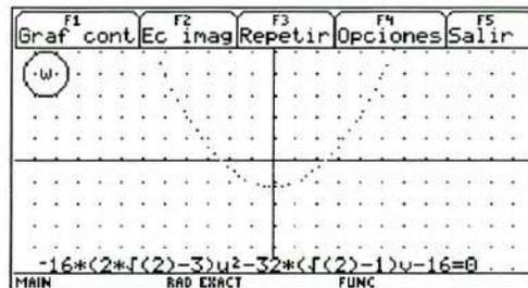
Fig. 3.3(b) Gráfica puntual de la imagen de la recta  $y = (\sqrt{2} - 1)x + 1$  en el plano  $w$  bajo la transformación  $w = (1 + i)z^2$ . Se trata de la parábola  $16(3 - 2\sqrt{2})u^2 - 32(\sqrt{2} - 1)v - 16 = 0$ , cuyo vértice es el punto  $V\left(0, -\frac{\sqrt{2} + 1}{2}\right)$ .
