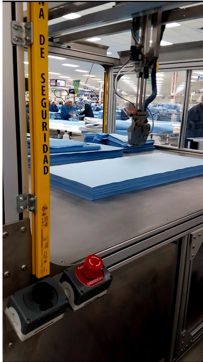
Figura 4.2 Maquina aplicando adhesivo.
