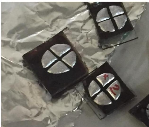
**Figura 18.** *Fotografía de las celdas solares basadas en perovskita con FM como cátodo.*
