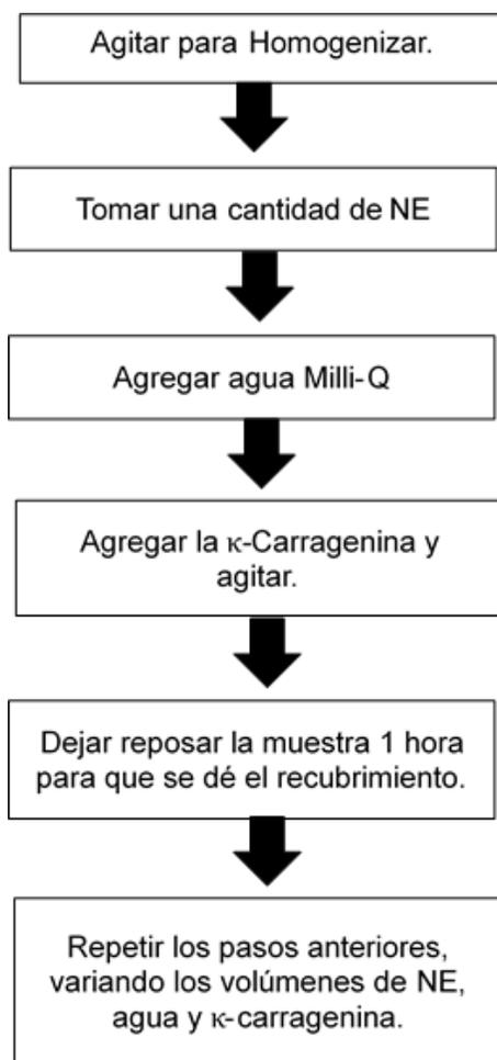
**Figura 18.** Diagrama de flujo del procedimiento llevado a cabo para el recubrimiento con polímero κ-Carragenina
